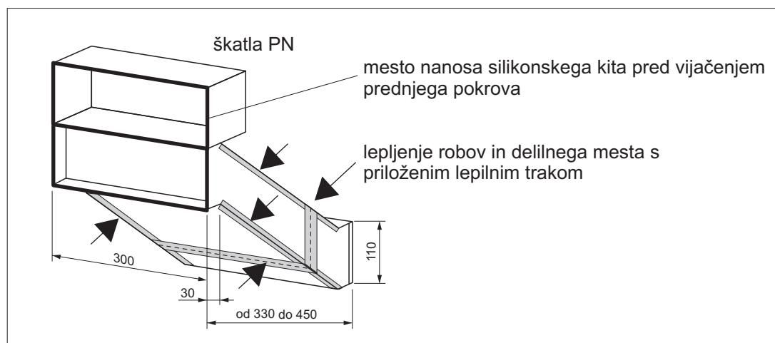
Betonski pokrov betonskega elementa za PN se ne zlepí, dokler ni zmontirana škatla PN. To nam omogoča, da z dostopom z zgornje strani škatlo PN fiksiramo s klinastimi zagozdami ali s PUR-peno.
